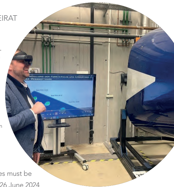
Abbildung 2: Augmented Reality im Praxiseinsatz bei der Prüfung von Beschädigungen am Flugzeugrumpf
